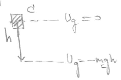
$$\frac{I_A \omega_A^2}{2} + \frac{I_B \omega_B^2}{2} + \frac{m_C v_C^2}{2} = m_C g h$$
