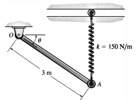
Dados: O momento de inércia de uma barra de massa  $m$  e comprimento  $L$ , em torno do eixo que passa pelo ponto  $O$ , perpendicular ao plano da página, é igual a  $I = (mL^2)/3$ .
